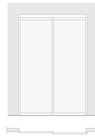
2 ANTE - BINARIO A 2 VIE LARGEZZA MINIMA MM 965 LARGEZZA MASSIMA MM 2365 ALTEZZA MASSIMA MM 3000.
