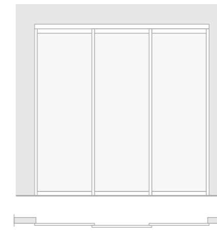
3 ANTE - BINARIO A 2 VIE LARGEZZA MINIMA MM 1430 LARGEZZA MASSIMA MM 3530 ALTEZZA MASSIMA MM 3000.
