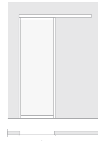
1 ANTA - BINARIO AD 1 VIA LARGEZZA MINIMA MM 600 LARGEZZA MASSIMA MM 1200 ALTEZZA MASSIMA MM 3000.
