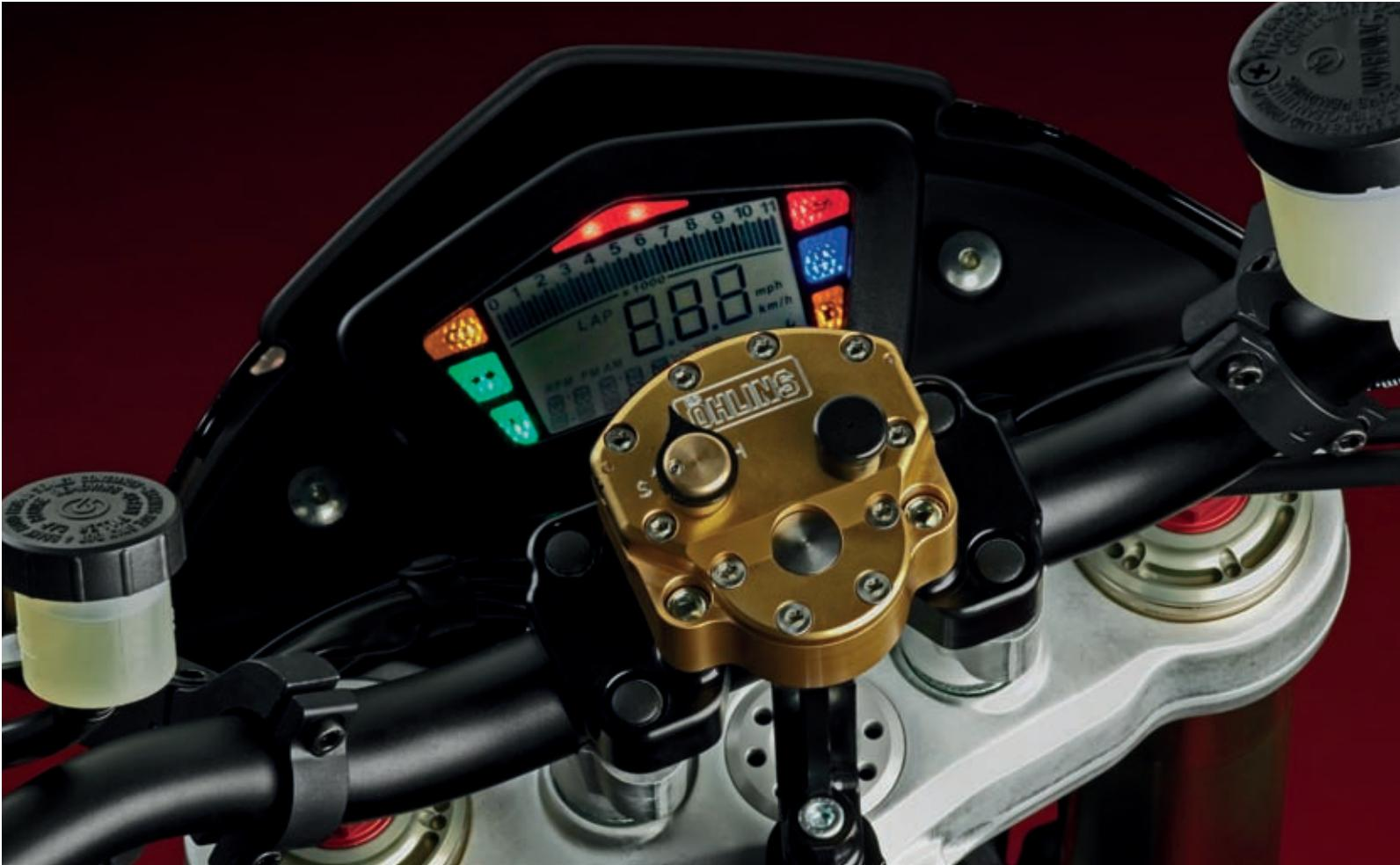
Ammortizzatore di sterzo trasversale in alluminio; tramite l'apposita manopola di regolazione consente di variare la risposta dell'ammortizzatore per dare più stabilità all'avantreno in relazione al proprio stile di guida.
