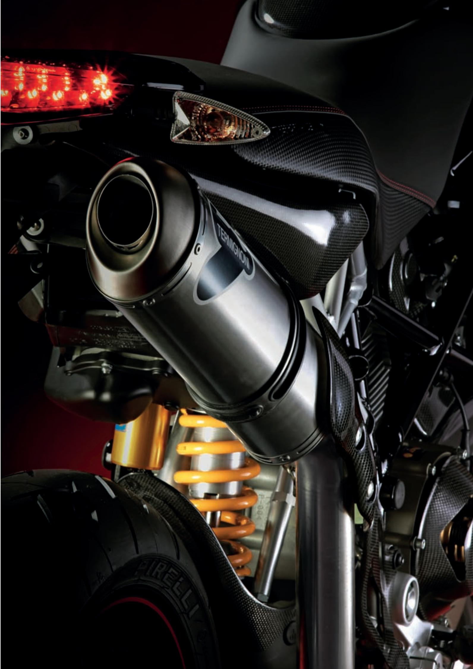
Kit gruppo di scarico racing 2 in 1 con collettori in acciaio inox (Ømax 54mm) e silenziatore in carbonio con fondello in titanio. L'impianto è dotato di dB killer estraibile e vengono forniti a corredo la centralina elettronica, la scatola filtro racing ed alcuni elementi, tra cui una coppia di fianchetti, che hanno la funzione di integrare perfettamente lo scarico al retroreno della moto. Oltre ad incrementare le prestazioni il gruppo consente anche di alleggerire il veicolo di circa 7kg.
